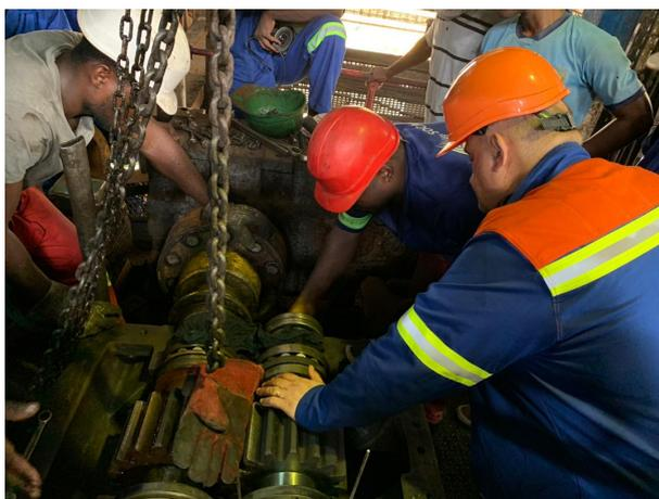
*Formation au montage/démontage d'un roulement, site de Kienké*
